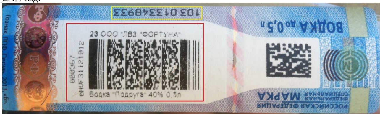
Рисунок 1. Изображен номер марки, формируемый АО «Гознак» при ее производстве, обведен желтой рамкой. Двумерный штрих код PDF-417 обведен красной рамкой.
